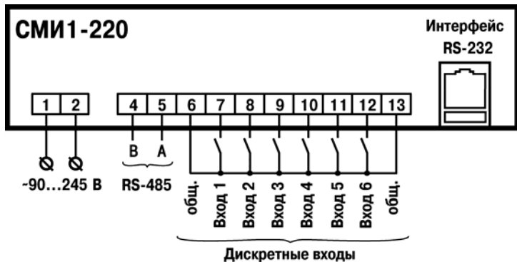
Рисунок Б.1 – Схема подключения питания, дискретных входов, интерфейсов RS-232 и RS-485 панели CMI1-220
