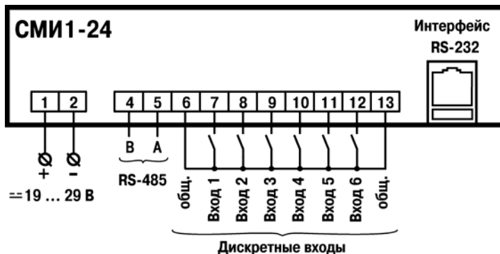
Рисунок Б.2 – Схема подключения питания, дискретных входов, интерфейсов RS-232 и RS-485 панели СМІ1-24
